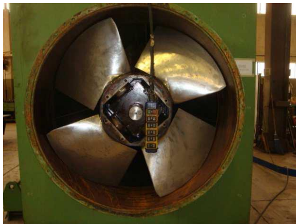
Gruppo turbina/generatore in officina
