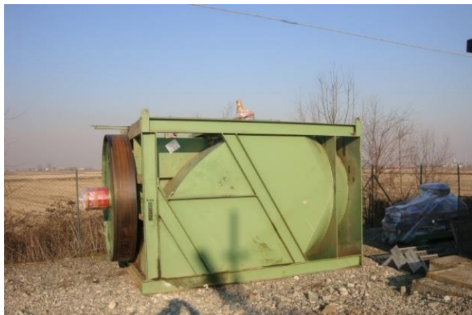
Gruppo turbina/generatore smontato
