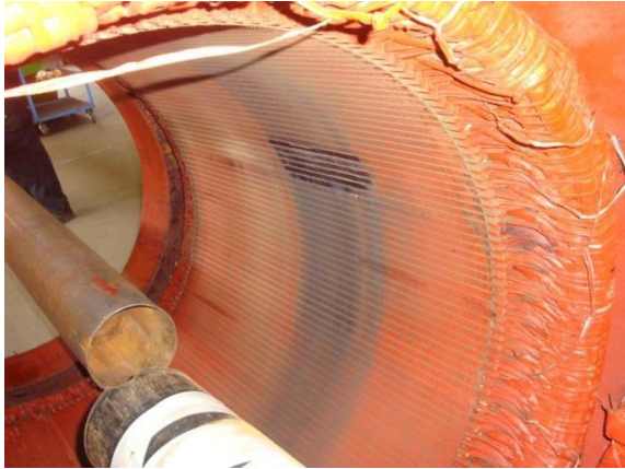
Pacco statorico con localizzazione guasto e slabbramento delle cave
