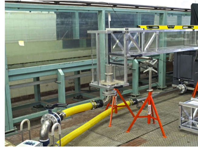
Confronto misurazione portata correntometro AIOS vs strumentazione universitaria
